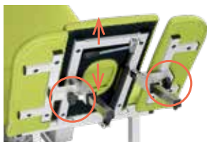
Podhlavník se nastavuje do určité polohy nadzvednutím a přidržetím pákového mechanismu. Po uvolnění se podhlavník zablokuje v této poloze. Postranice podhlavníku se spouštějí tím, že povolíme okřídlený šroub, postranici sesuneme do požadované polohy a šroub utáhneme.
