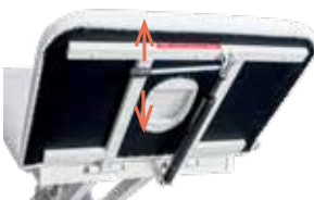
Podhlavník se nastavuje do určité polohy nadzvednutím a přidržetím pákového mechanismu. Po uvolnění se podhlavník zablokuje v této poloze. Postranice podhlavníku se spouštějí tím, že povolíme okřídlený šroub, postranici sesuneme do požadované polohy a šroub utáhneme.
